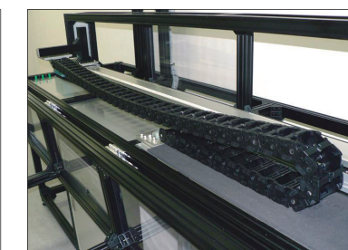
Cableveyor bend tester
